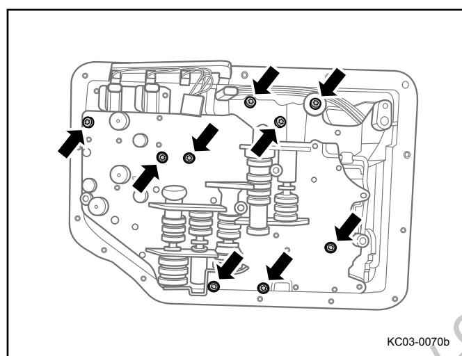
3. 安装并紧固变速器控制阀体固定螺栓。
