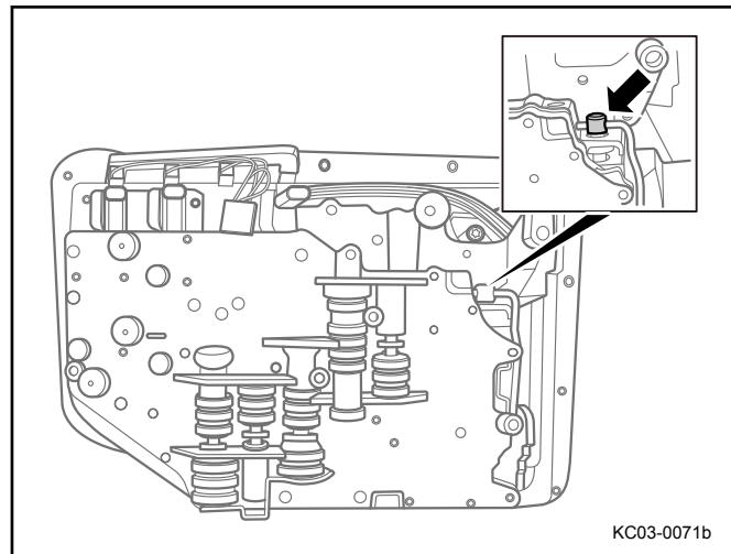
2. 安装变速器控制阀体，同时将换档连接杆插入换档手动阀。
