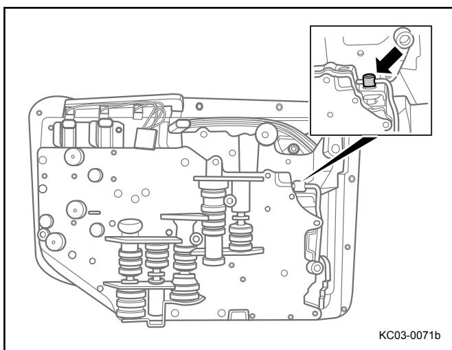
11. 取出变速器控制阀体，同时从换挡联动杆上脱开换挡连接杆。
