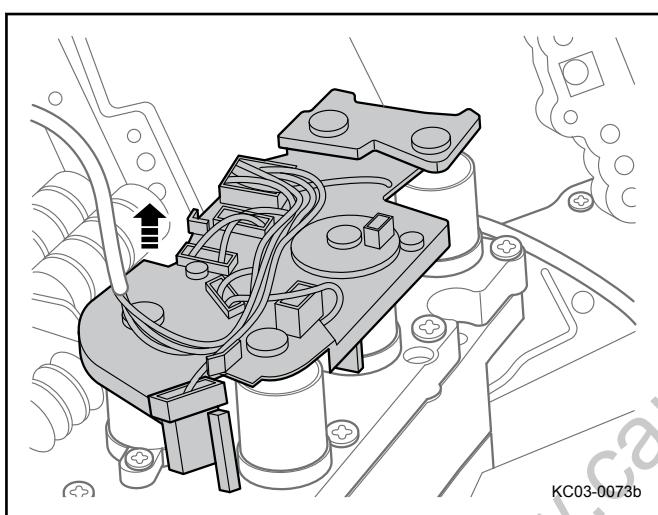
12. 断开变速器 S5~S10 电磁阀线束连接器。
