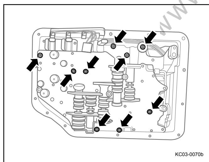
10. 拆卸变速器控制阀体固定螺栓。
